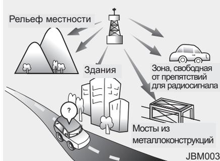
FM сигнал передается на высоких частотах и не искривляется, проходя вдоль поверхности Земли. Поэтому FM сигнал обычно начинает затухать на коротком расстоянии от радиопередающей станции. Кроме того FM сигналы легко нарушаются зданиями, горами и другими препятствиями. Это может привести к определенным состояниям при воспроизведении звука, которые могут выглядеть как неисправность радио. Указанные ниже состояния являются нормальными и не указывают на неисправность радио.
