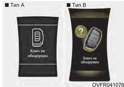
Если электронный ключ не находится в автомобиле или не обнаружен, при нажатии кнопки запуска/остановки двигателя на ЖК-экране в течение 10 с будет высвечиваться это предупреждение. Кроме того, индикатор иммобилайзера будет гореть в течение 10 с.
