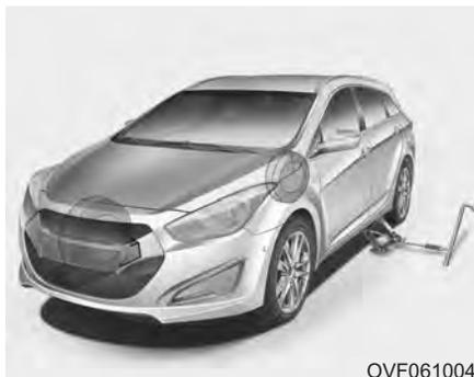
4. Извлеките из автомобиля гаечный ключ для колесных гаек, домкрат, рукоятку домкрата и запасное колесо.
