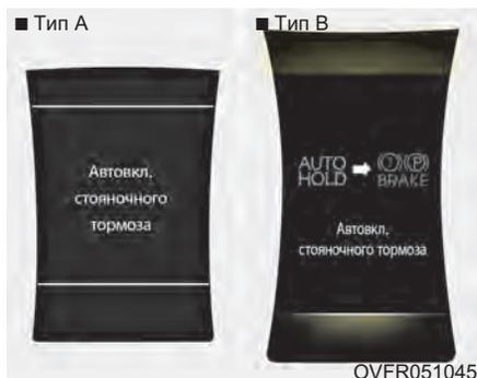
В случае применения электрического стояночного тормоза по команде электронной системы динамической стабилизации (ESP) при активном режиме автоматического удержания, подается предупредительный звуковой сигнал и отображается сообщение.
