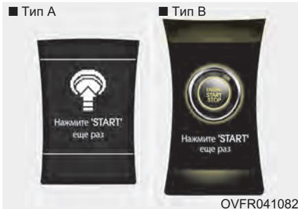
Если кнопка пуска/останова двигателя не работает вследствие проблем с системой кнопки пуска/останова двигателя, аварийный сигнал будет гореть 10 минут, а колокольчик звучать непрерывно. Это означает, что можно запустить двигатель, еще раз нажав кнопку пуска/останова двигателя.
