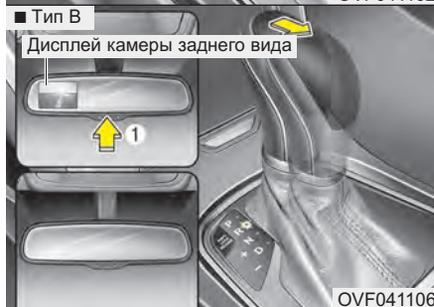
Камера заднего вида включается при включенном фонаре заднего хода, включенном зажигании и рычаге переключения передач в положении “R” (Задний ход).
