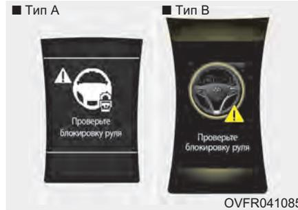
Если при переходе кнопки пуска/остановки двигателя в положение OFF рулевое колесо не заблокируется штатным образом, на ЖК-дисплее в течение 10 с будет отображаться предупреждающее сообщение. Кроме того, колокольчик будет звучать 3 секунды, а индикатор кнопки пуска/останова двигателя будет мигать 10 секунд.
