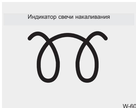
3. Поверните выключатель зажигания в положение ON (ВКЛ) для предварительного прогрева двигателя. После этого загорится лампа индикатора свечи накаливания.
