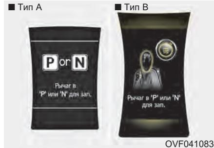
Если попытаться запустить двигатель, когда рычаг переключения передач не установлен в положение “P” (Парковка) или “N” (Нейтраль), на ЖК-экране в течение 10 с будет высвечиваться это предупреждение.
