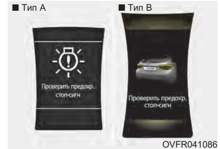
При отключении предохранителя стоп-сигнала на ЖК дисплее на 10 сек загорается предупреждающее сообщение. Замените предохранитель. Если это невозможно, двигатель можно запустить, нажав кнопку пуска-остановки и удерживая ее в течение 10 с в положении АСС.
