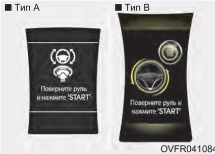
Если при нажатии кнопки пуска/остановки двигателя рулевое колесо не разблокируется штатным образом, на ЖК-дисплее в течение 10 с будет отображаться предупреждающее сообщение. Кроме того, колокольчик прозвучит один раз, а индикатор кнопки пуска/останова двигателя будет мигать 10 секунд. Получив аварийный сигнал, нажмите кнопку пуска/останова двигателя, одновременно поворачивая рулевое колесо вправо и влево.
