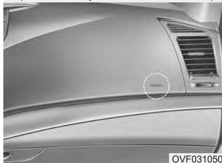
Система SRS предназначена для дополнительной (кроме системы ремней безопасности) защиты водителя от сильного фронтального удара.
