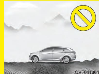
При парковке на неровной дороге водителю необходимо использовать надлежащим образом педали (сцепления, акселератора или тормоза). В противном случае система может выключиться при пробуксовывании колес и создается опасность дорожно-транспортного происшествия.
