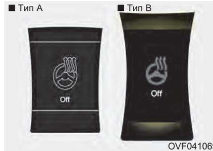
При выключении подогрева рулевого колеса индикатор гаснет.
