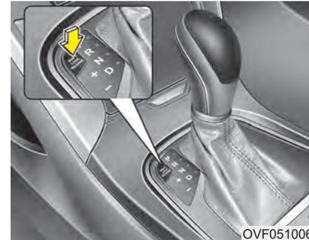
**Разблокирование стопора включения передачи**
