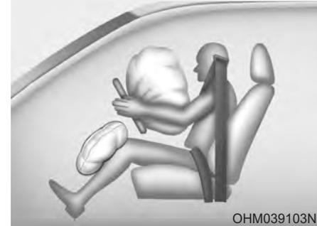
При раскрытии разрывные швы в крышках подушек безопасности расходятся под давлением раскрытия подушек. Затем крышки открываются, что позволяет подушкам безопасности полностью раскрыться.
