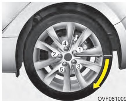
Затем расположите гаечный ключ, как показано на рисунке, и затяните колесные гайки. Следите за тем, чтобы гнездо гаечного ключа полностью охватывало гайку. Не вставляйте на рукоятку гаечного ключа и не используйте трубу в качестве удлинителя рукоятки.
