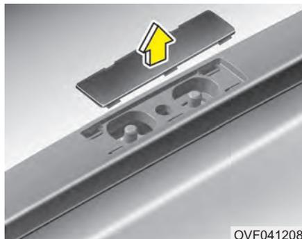
2. После использования релинга установите крышку на крышу в обратном порядке.
