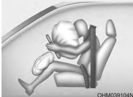
Полностью раскрытая подушка безопасности вместе с правильно пристегнутым ремнем безопасности замедляют перемещение водителя вперед и снижают риск травмирования головы и грудной клетки.
