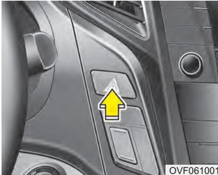
Огни аварийной сигнализации следует включать при каждой экстренной остановке в опасном месте. В случае экстренной остановки съезды с проезжей части как можно дальше в сторону. Огни аварийной сигнализации включаются нажатием выключателя аварийной сигнализации. При этом начинают мигать все указатели поворота. Огни аварийной сигнализации горят даже при отсутствии ключа в замке зажигания.
