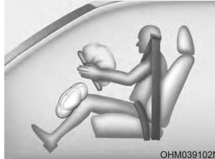
Модули фронтальных подушек безопасности расположены в центре рулевого колеса и на передней панели пассажира на перчаточном ящике и/или в коленном буфере со стороны водителя. Если блок SRSCM регистрирует фронтальный удар достаточной силы, он автоматически раскрывает передние подушки безопасности.
