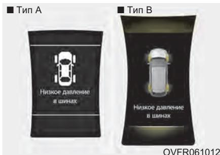
Индикаторное устройство положения колеса с низким давлением отображается при обнаружении низкого давления в одной или нескольких шинах. Он определит недостаточно накачанную шину.
