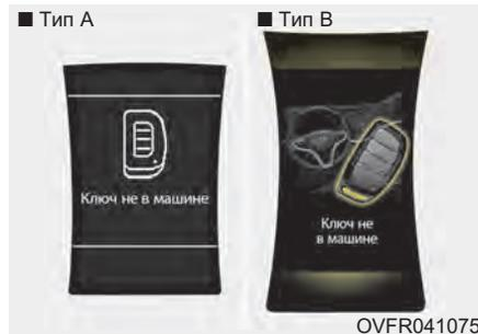
Если электронный ключ не в машине и открывается или закрывается какая-либо дверь, когда ключ зажигания находится в положении ACC, ON или START, на ЖК-экране высвечивается предупреждение. Кроме того, при закрытии двери, когда электронный ключ не в машине, в течение 5 с будет звучать колокольчик.
