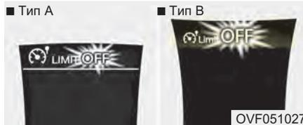
При возникновении проблемы с системой регулировки ограничения скорости замигает индикатор “OFF”.
