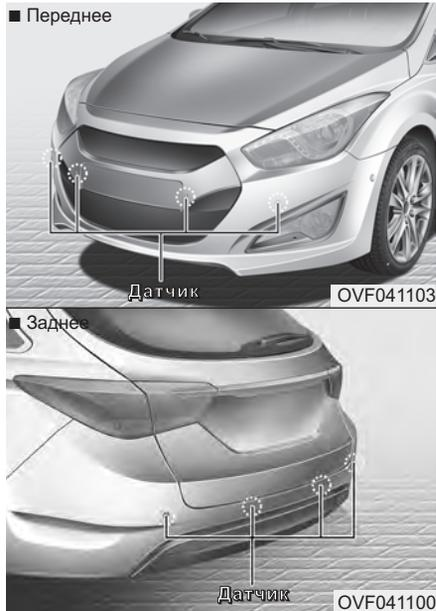
Система помощи при парковке подает звуковые сигналы при обнаружении какого-либо объекта на расстоянии до 120 см спереди и сзади автомобиля. Эта система является вспомогательной. Она не может заменить внимания и аккуратности водителя, и не предназначена для этого.
