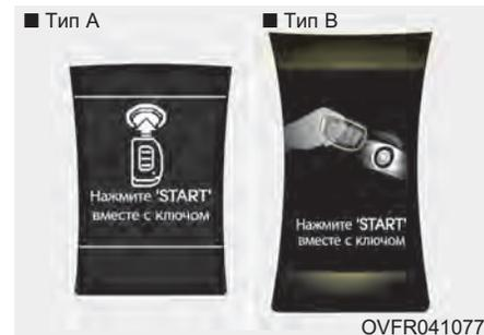
При нажатии кнопки пуска/останова двигателя, когда горит сигнал "Key is not detected" (Ключ не обнаружен), на ЖК-дисплее в течение 10 с будет гореть предупреждение "Press the start button with smart key" (Нажмите 'START' вместе с ключом). Кроме того, индикатор иммобилайзера будет гореть в течение 10 с.
