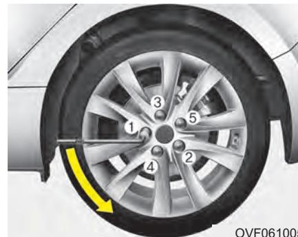
6. Ослабьте колесные гайки, повернув их против часовой стрелки на один оборот, но не снимайте гайки до тех пор, пока автомобиль не будет поднят на землей.
