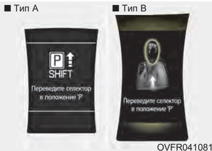
При попытке останова двигателя, когда рычаг переключения передач не находится в положении “P” (парковка), кнопка пуска/останова двигателя перейдет в положение АСС. При повторном нажатии кнопки она перейдет в положение ON.
