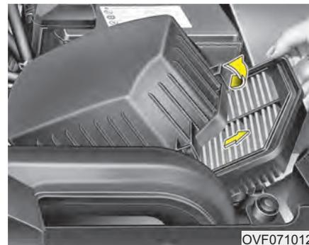
2. Протрите внутреннюю часть воздушного фильтра.
