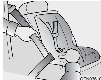
3. Пристегните ремень безопасности и полностью выберите слабину. После установки детского удерживающего устройства проверьте ее надежность, подвигав устройство во всех направлениях.
